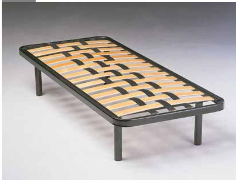
RETE ORTOPEDICA IN METALLO VERNICIATO CON POLVERI EPOSSIDICHE ANTIGRAFFIO CON STRUTTURA COSTITUITA DA UN TELAIO IN TUBOLARE SEMIOVALE DA MM. 50X25 CURVATO. PIANO D'APPOGGIO CON N. 14 DOGHE DI LEGNO CURVATE A VAPORE DELLO SPESSORE DI MM. 8 E DELLA LARGHEZZA DI MM. 68, CINTE ELASTICHE DI RINFORZO. PIEDI IN METALLO VERNICIATI FISSI. PRODOTTA IN DIVERSE DIMENSIONI SIA IN LARGHEZZA CHE IN LUNGHEZZA.
