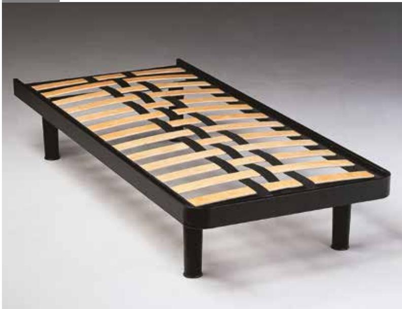
SOMMIER IN METALLO VERNICIATO CON POLVERI EPOSSIDICHE ANTIGRAFFIO CON STRUTTURA COSTITUITA DA UN TELAIO IN TUBOLARE RETTANGOLARE DA MM. 80X20 CURVATO. PIANO D'APPOGGIO CON N. 10 DOGHE DI LEGNO PIANE DELLO SPESSORE DI MM. 8 E DELLA LARGHEZZA DI MM. 130 INCASSATE SULLA STRUTTURA, CINTE ELASTICHE DI RINFORZO. PIEDI IN METALLO VERNICIATI O IN PVC, FISSI O CON RUOTE UNIDIREZIONALI. PRODOTTO IN DIVERSE DIMENSIONI SIA IN LARGHEZZA CHE IN LUNGHEZZA.
