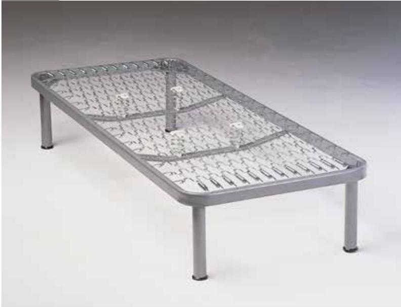
RETE SEMIORTOPEDICA IN METALLO VERNICIATO CON POLVERI EPOSSIDICHE ANTIGRAFFIO CON STRUTTURA COSTITUITA DA UN TELAIO IN TUBOLARE SEMIOVALE DA MM. 50X25 CURVATO, CON DUE TRAVERSE INFERIORI ANTIAFFOSSAMENTO E MOLLONI DI RINFORZO. PIANO D'APPOGGIO CON N. 12 FILE DI MOLLA GRECA ZINCATA E N. 6 MOLLE DI TESTA PER LATO. PIEDI IN METALLO VERNICIATI FISSI. PRODOTTA IN DIVERSE DIMENSIONI SIA IN LARGHEZZA CHE IN LUNGHEZZA.
